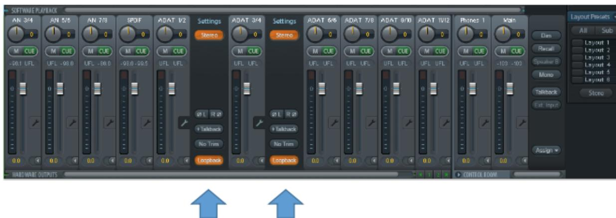
Die AUSGÄNGE ADAT 1/2 und ADAT 3/4 müssen beide auf Loopback gestellt werden. Hierzu das Schraubenschlüsselmenü bei den beiden Ausgängen öffnen und hier die Schalter Loopback aktivieren.
