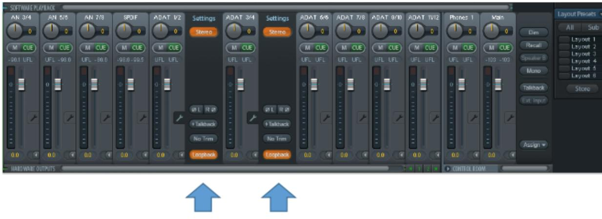
Die AUSGÄNGE ADAT 1/2 und ADAT 3/4 müssen beide auf Loopback gestellt werden. Hierzu das Schraubenschlüsselmenü bei den beiden Ausgängen öffnen und hier die Schalter Loopback aktivieren.
